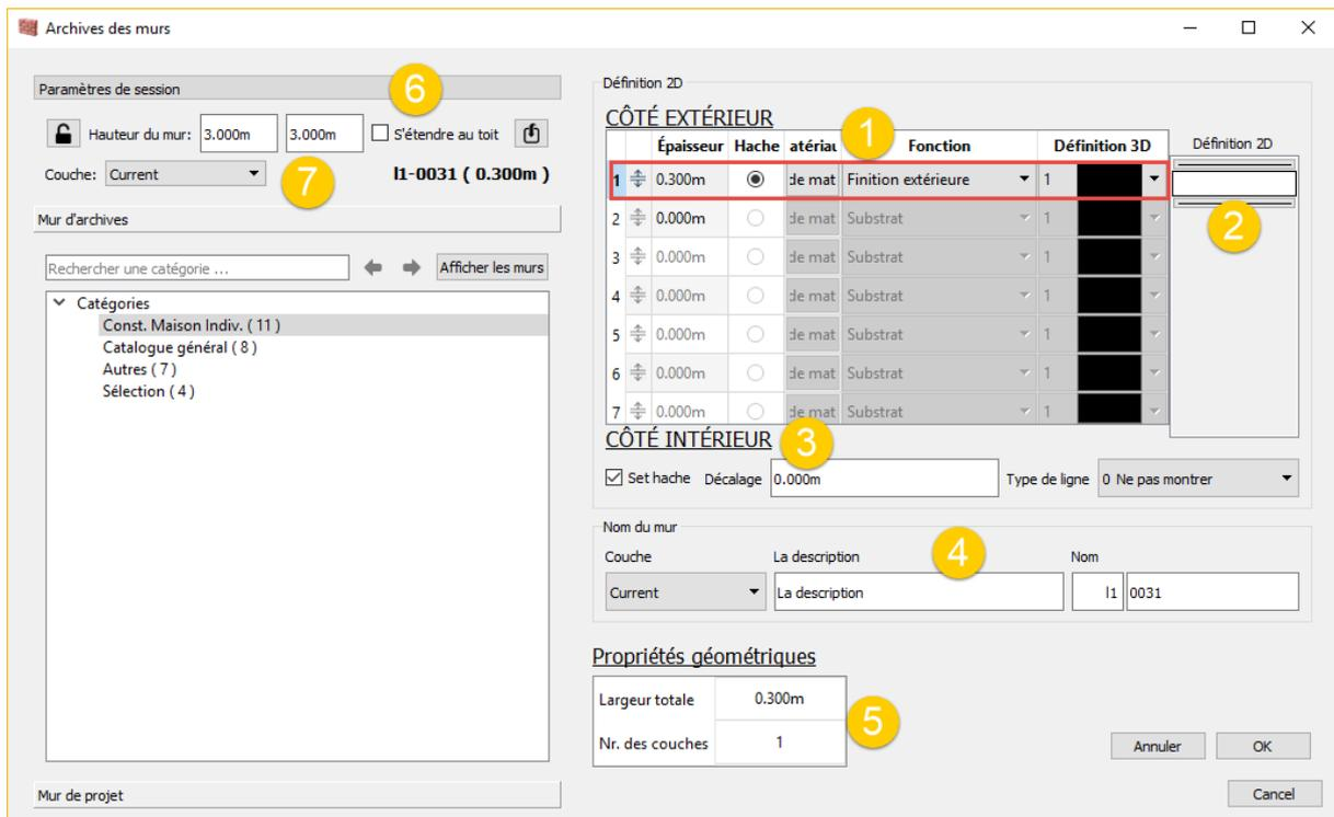
1. Couche crée par définition : définition de l'épaisseur / Matériau et Fonction font appel aux paramètres BIM de la couche sélectionnée / Définition 3D (couleur de ligne)
